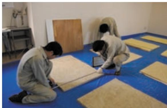
写真2 寸法の測定
