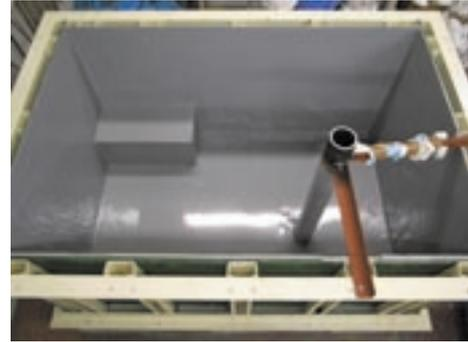
写真3 水密試験用試験体の作製状況
