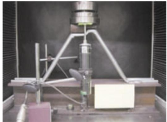
写真3 タイトフレーム及び固定金具の圧縮試験
