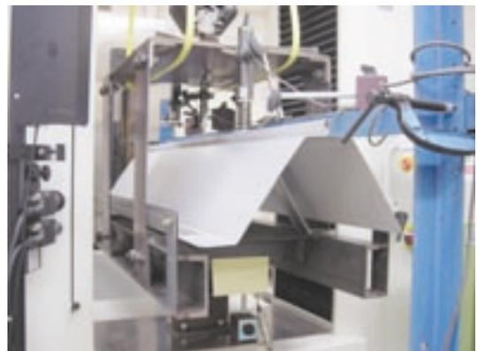
写真4 折板及び固定金具の引張試験
