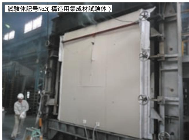
写真3 試験終了時(座屈破壊直後)の非加熱側の状況
