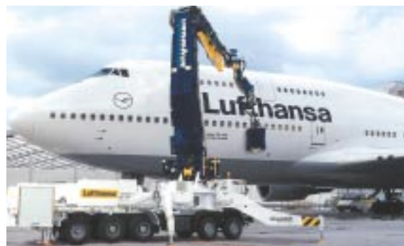
写真2 高圧洗浄機による航空機の洗浄 4)
