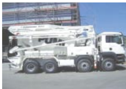
写真3 トラックミキサとポンプが一体となった機種(PUMI)の外観
