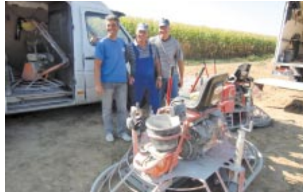
写真8 上面仕上げに使用する騎乗式機械
