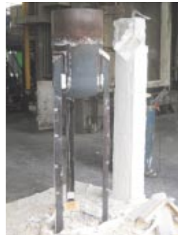
写真b 試験後の試験体の状況 (上：試験終了直後、下：被覆材を取り除いた状況)
