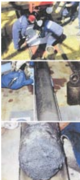
図4 メタンハイドレート天然試料のサンプリング 11)
