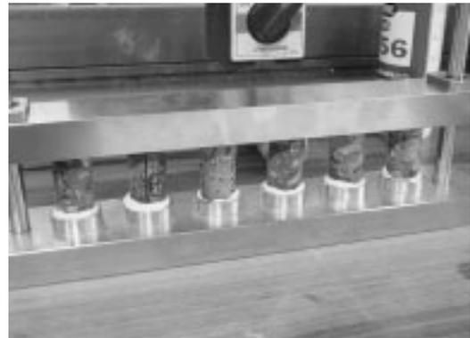
写真5 小径コアのキャッピング状況
