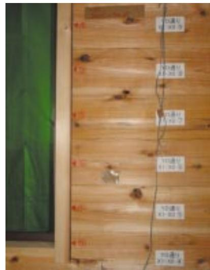
写真7 ログ材の水平ずれ発生状況
