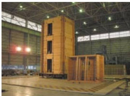
写真9 一次元振動試験の3階建て試験体
