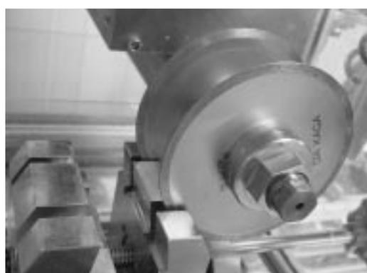
写真2 小径コア切断機の2枚刃
