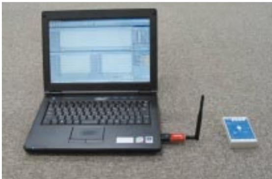
写真1 無線加速度計測と計測用PC
