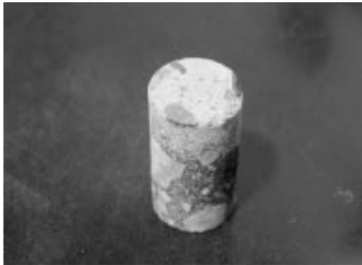
写真3 切断された小径コア供試体
