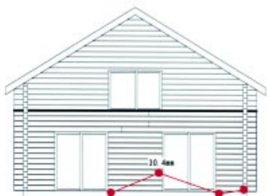
図9 1階脚部のログ材の浮き上がり状況
