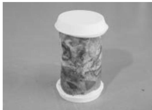
写真6 キャッピング後の小径コア供試体
