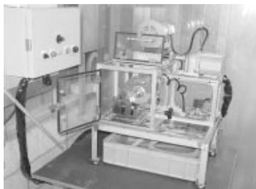
写真1 小径コア切断機の全景
