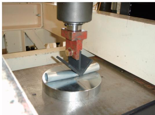
写真3 アルミニウム管特性値測定 (圧縮実験)
