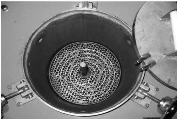
写真3 促進試験に使用した反応促進装置 (JIS A1804)
