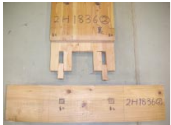
込栓とほぞのせん断破壊
