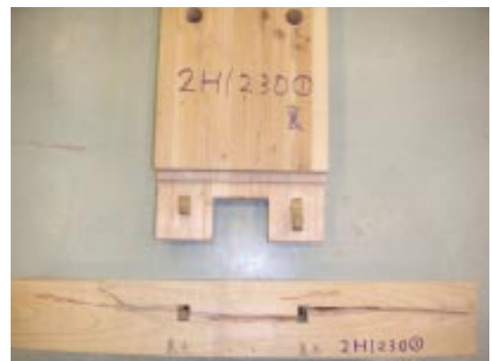
柱の割裂破壊
