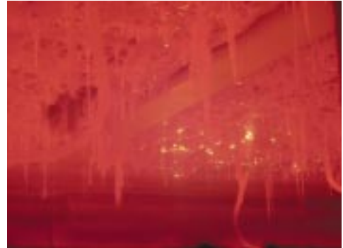
図15 加熱開始後40分時の下面 ガラス張仕様
