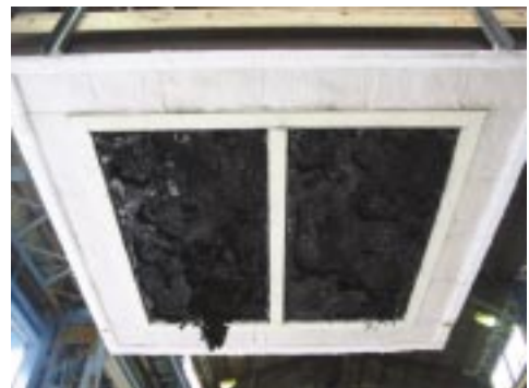
図16 試験後の下面 ガラス張仕様
