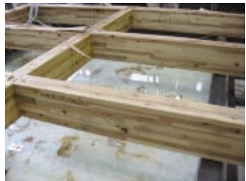
図17 試験後の木梁 ガラス張仕様
