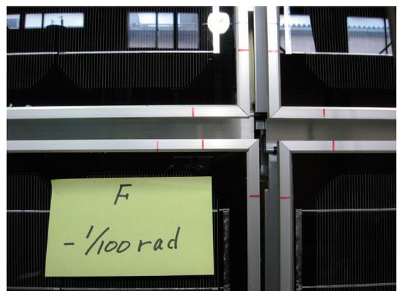
写真2 目標層間変形角-1/100rad時の試験体の状況
