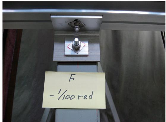
写真4 目標層間変形角-1/100rad時の試験体の状況
