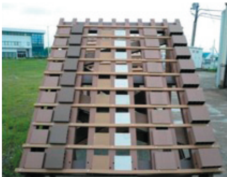
写真1 屋外暴露試験（JIS A 1456準拠）試験体の暴露状況
