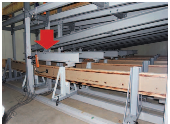
写真1 パーティクルボードを床下地材とする水平構面の水平せん断試験の様子
