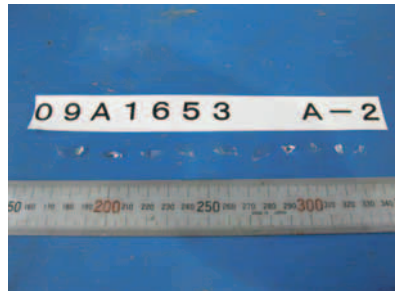
写真4 破壊状況 試験項目：ショットバッグ 試験片番号：A-2 ・飛散したガラス破片のうち、大きな破片10個の形状
