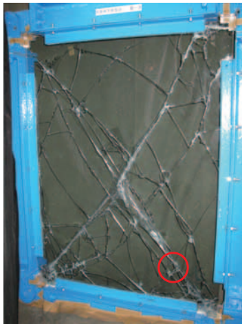
写真11 破壊状況 試験項目：層間変位 試験片番号：B-3 ・板ガラスの破壊及びフィルムの切れ (○部分でフィルムの切れ)
