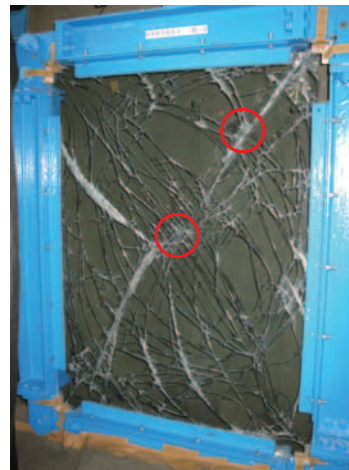
写真10 破壊状況 試験項目：層間変位 試験片番号：B-2 ・板ガラスの破壊及びフィルムの切れ (○部分でフィルムの切れ)
