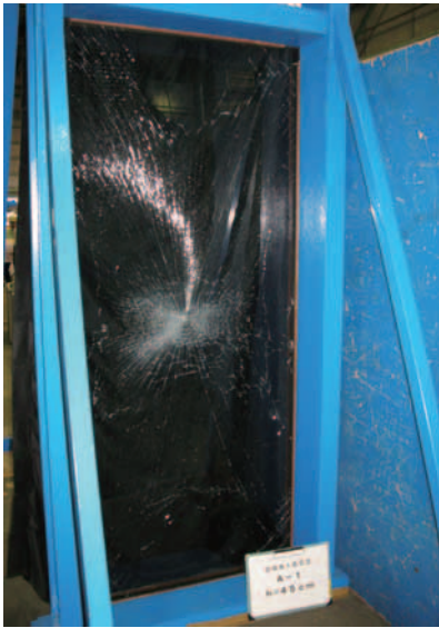
写真1 破壊状況 試験項目：ショットバッグ 試験片番号：A-1 ・板ガラスの破壊
