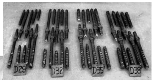
▲鉄筋継手試験片（引張試験後）
