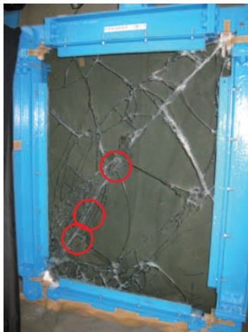
写真9 破壊状況 試験項目：層間変位 試験片番号：B-1 ・板ガラスの破壊及びフィルムの切れ (○部分でフィルムの切れ)
