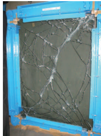
写真12 破壊状況 試験項目：層間変位 試験片番号：B-4 ・板ガラスの破壊
