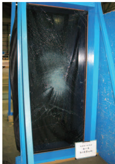
写真7 破壊状況 試験項目：ショットバッグ 試験片番号：A-4 ・板ガラスの破壊
