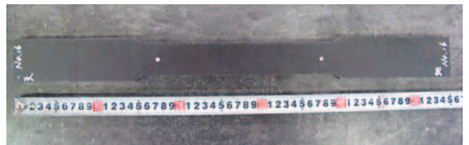
写真2 板状試験片 1A号
