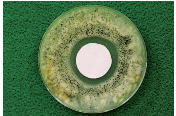
写真2 かび抵抗性試験結果の一例(評価対象:塗料)
