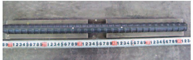
写真1 鉄筋コンクリート用棒鋼（JIS G 3112） 呼び名 D25（公称直径25.4mm） 棒状試験片 14A号に準じる
