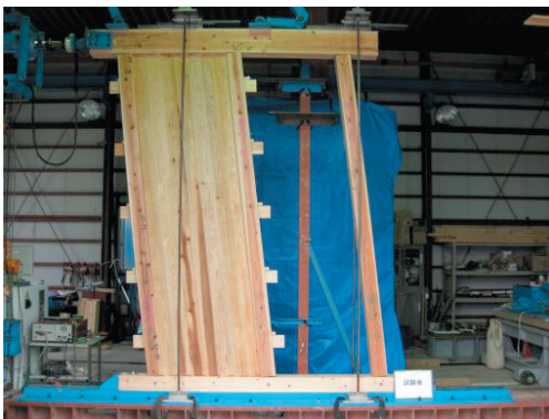
写真4 破壊状況（試験体記号：W-2-②）
