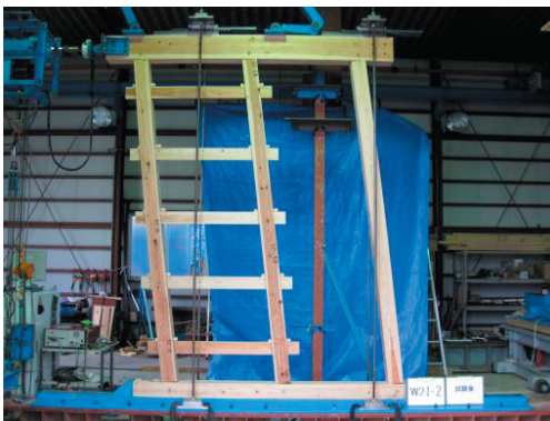
写真3 破壊状況（試験体記号：W-2-①）
