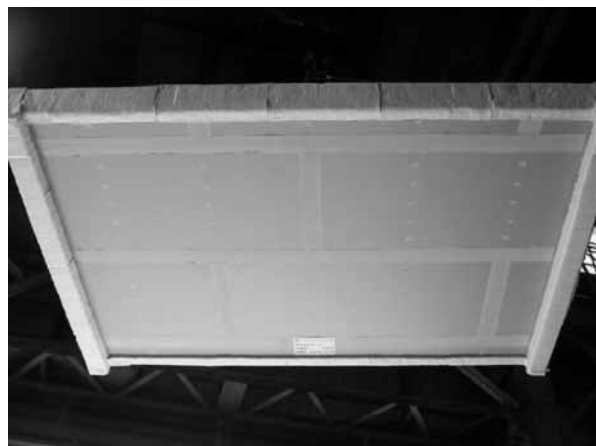
写真2 試験前の加熱側の状況(試験体記号B)
