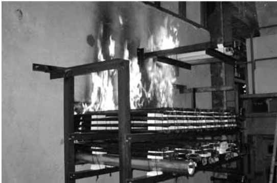
写真 耐火構造壁のケーブル貫通部の耐火試験
