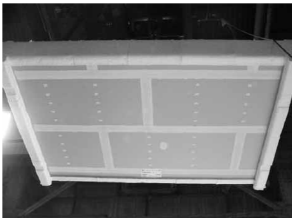
写真1 試験前の加熱側の状況(試験体記号A)
