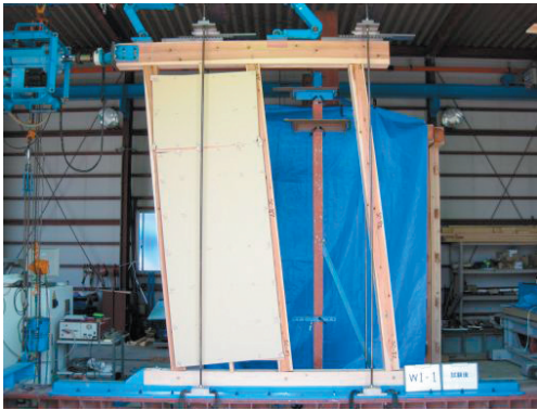
写真2 破壊状況（試験体記号：W-1-①）
