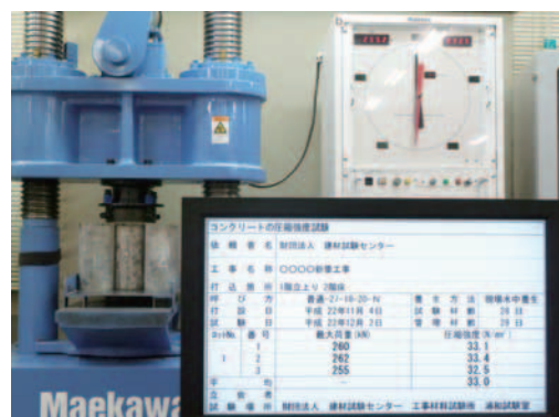
写真3. 「圧縮計測システム」導入後の圧縮強度試験状況写真 (試験機: 2000kN自動圧縮試験機, 黒板: ディスプレイに自動出力)
