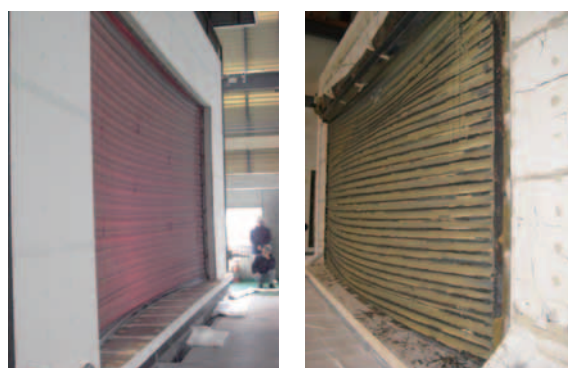
写真3 加熱中(30分時)及び終了後(屋内側)の状況
