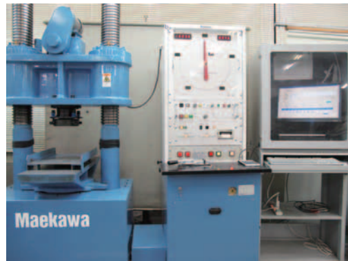
写真1 「2000kN自動圧縮試験機」と「圧縮計測システム(デジタル検力器及びパソコン)」
