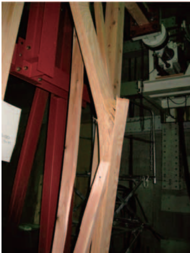
写真1 筋かいの座屈破壊 (LVL最外層単板の縦継ぎ部で破断し、徐々に内層単板の破壊に繋がっていることが分かる)
