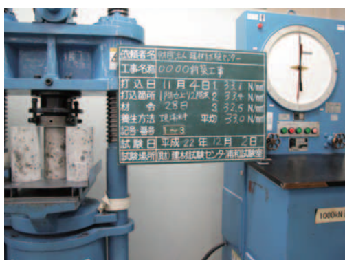
写真2. 従来の圧縮強度試験状況写真 (試験機: アナログの1000kN圧縮試験機, 黒板: 木製黒板にチョークで記入)
