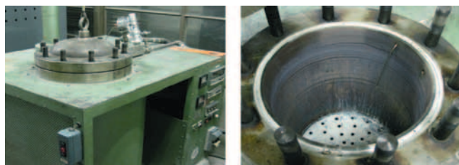
写真3 オートクレーブ装置 (JIS A 6205) の外観
