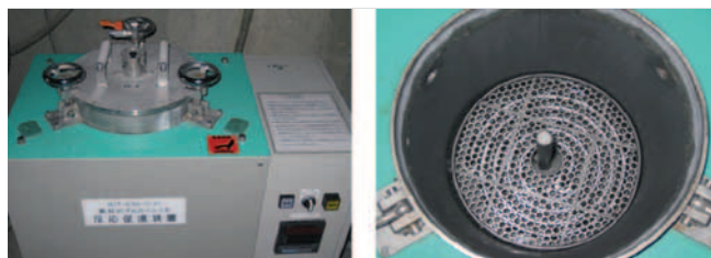
写真2 反応促進装置 (JIS A 1804) の外観
