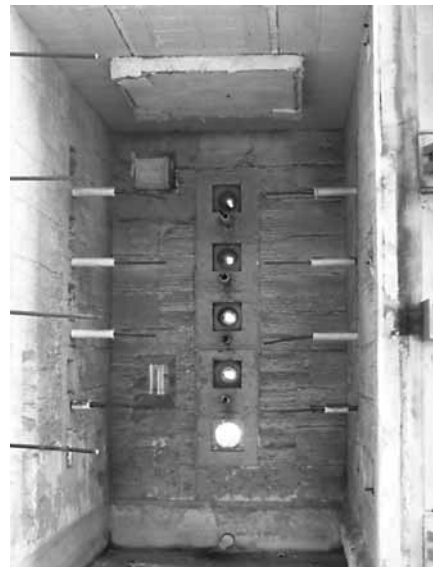
写真2 軽油燃焼バーナーの燃焼状況
