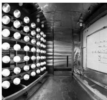
外装材の温冷繰返し耐久性試験
