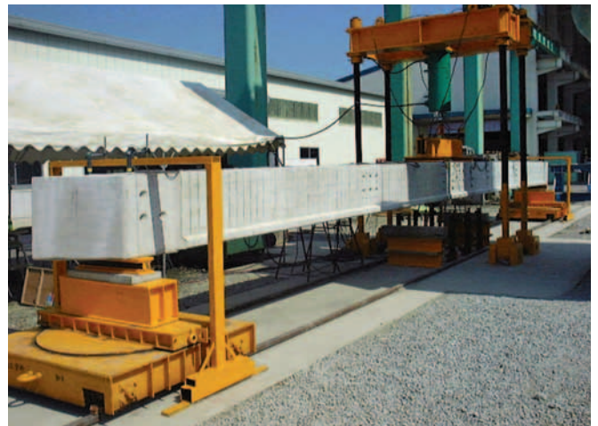
写真3 実規模PC桁の載荷実験状況
