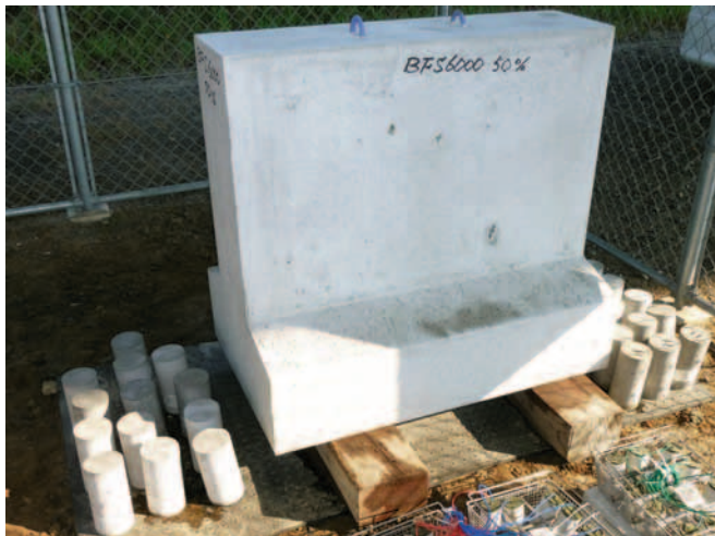
写真6 曝露試験用供試体の設置状況
