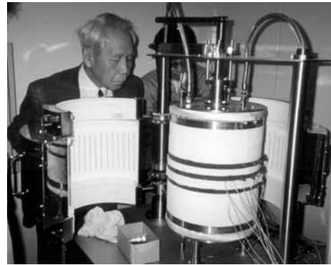
当センターに完成した高温断熱材の熱伝導率測定装置に見入る藤井正一先生。 円筒の中央が加熱板で、その上下が試料。半円筒状の側面断熱部を外したところ。
