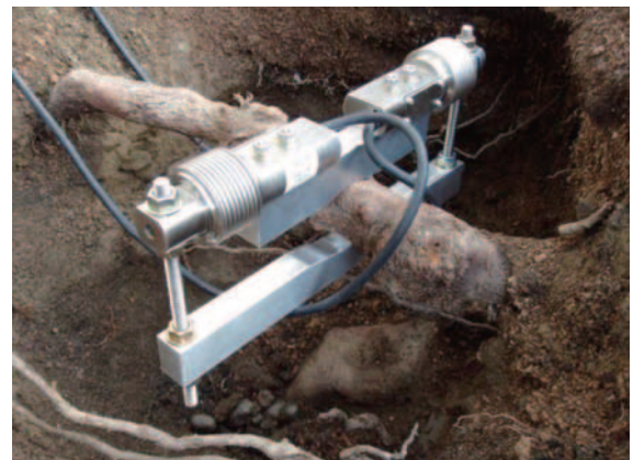
写真5 肥大力測定装置の設置状況
