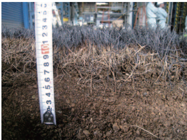
写真12 枯れたノシバの延焼部分断面
