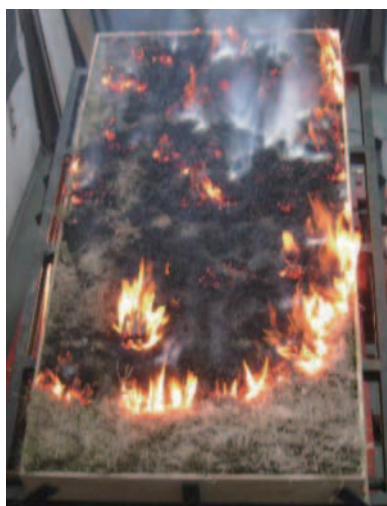
写真10 枯れたノシバ試験中状況
