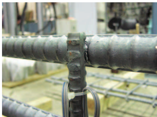
写真1 スポット溶接接合
