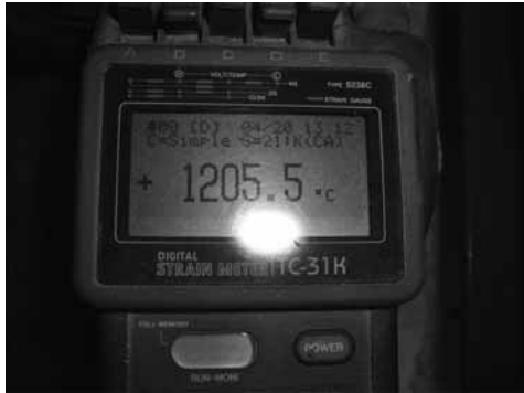
写真2 バーナーの炎の温度確認状況
