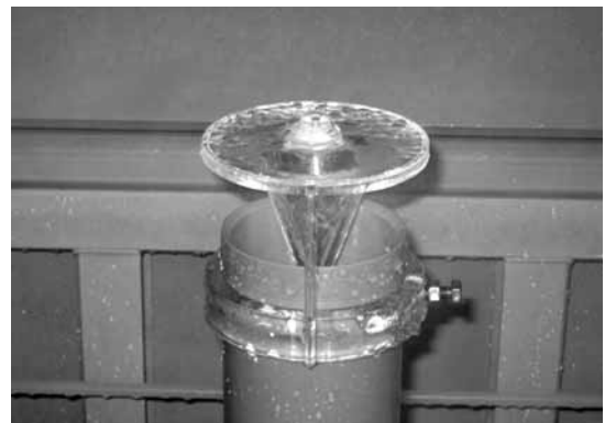
写真2 噴霧塔からの霧の発生状況
