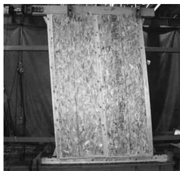
木造耐力壁の面内せん断試験
