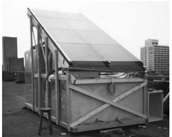
写真1 塩化リチウム水溶液を用いた太陽熱利用開放型涼房・給湯装置の1981年モデル，早稲田大学理工学部58号館屋上にて
