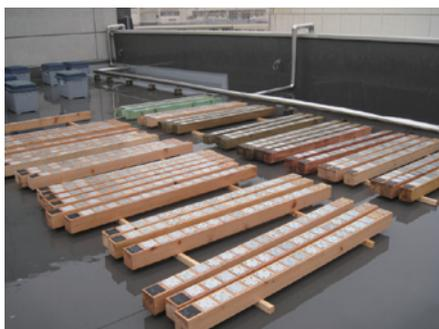
図9 屋外暴露試験
