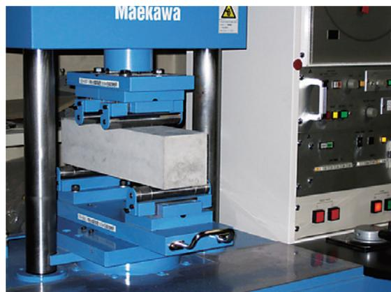
写真4 コンクリートの曲げ強度試験
