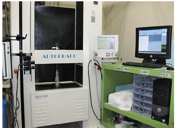
写真6 100kNオートグラフ万能試験機
