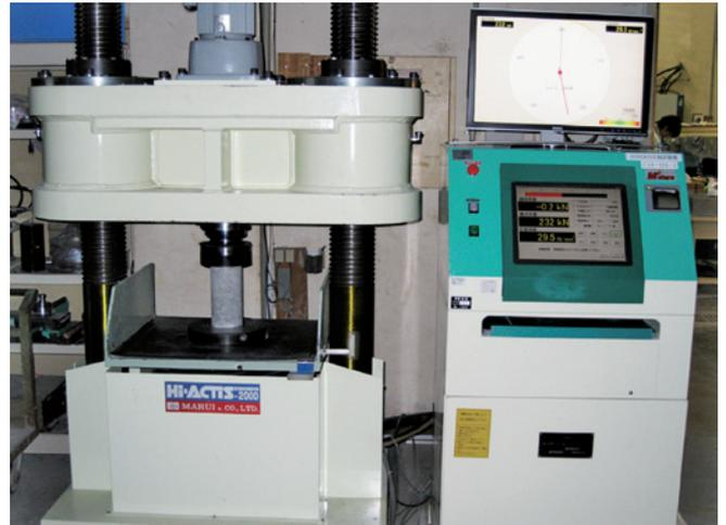
写真5 2000kN全自動耐圧試験機
