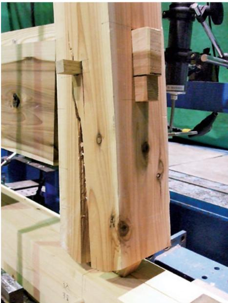
写真3 大変形時の状況(足固め有り)
