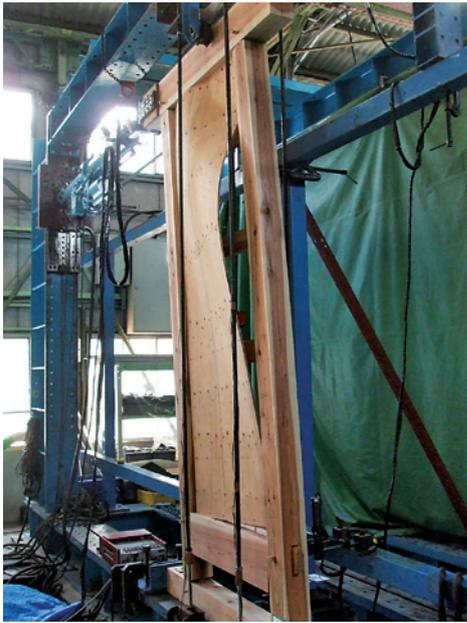
写真1 構造用合板試験体の破壊状況
