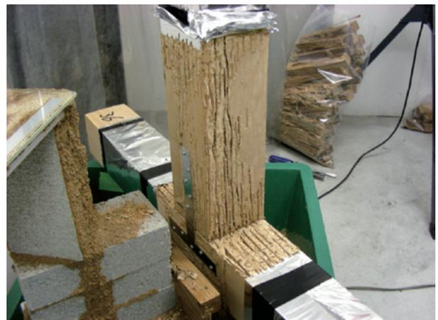
図6 シロアリ促進劣化モデル試験体
