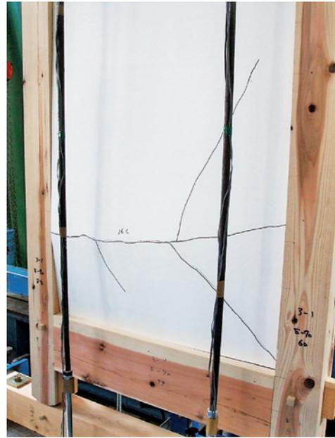
写真2 漆喰試験体の破壊状況
