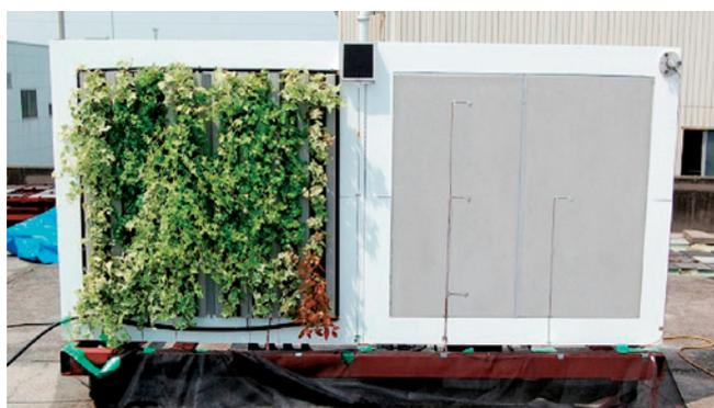
写真1 試験体外観（左側；緑化壁、右側；従来壁）
