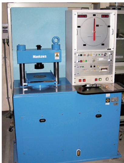
写真1 500kN全自動耐圧試験機
