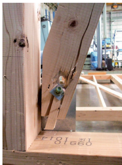
写真2 破壊状況，筋かいの割裂 (試験体記号：BP)
