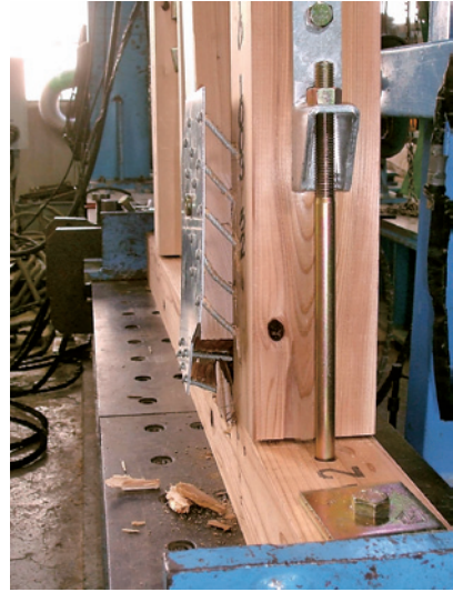
写真5 破壊状況、柱および横架材からのくぎの抜け (試験体記号: BP2)
