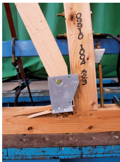
写真3 破壊状況，柱および横架材からのくぎの抜け (試験体記号：BP)
