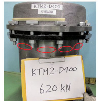
写真4 試験体記号：KTM-D400 試験後の状況 ・写真中の○が係止体の跡
