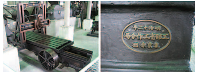
図2 菊花御紋章付 平削盤 (左) 全景(右) 製造の印「明治十二年 工部省工作分局 東京赤羽」 全長2,815mm、全幅1,230mm、全高1,680mm、 テーブル長2,060mm、テーブル幅 672mm (所蔵：博物館明治村 愛知県犬山市内山一番地)
