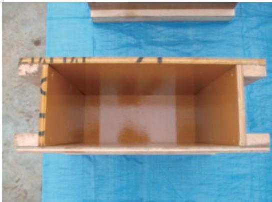
写真2 模擬基礎試験体用木製型枠
