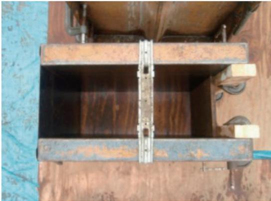
写真1 模擬基礎試験体用鋼製型枠
