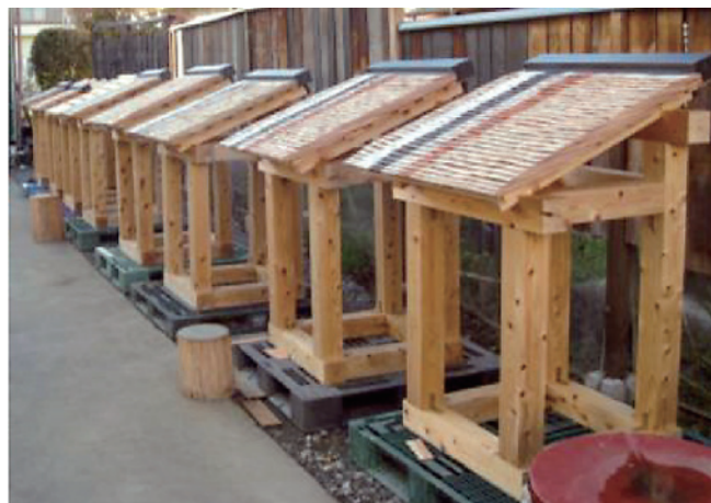
写真6 こけら実大試験の様子(山梨県甲州市)
