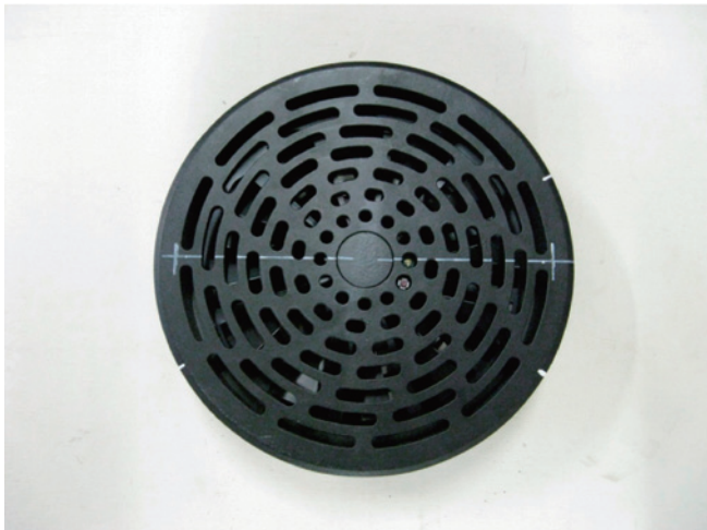
写真5 ローリングロード試験後の試験体の状況
