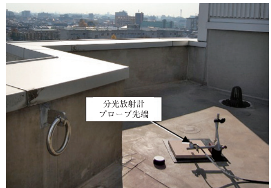
写真5 日射量(建材試験センター屋上)測定状況
