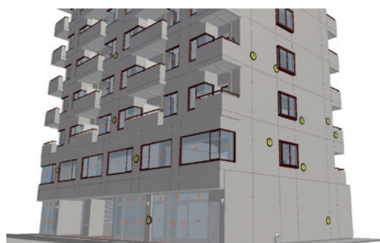
図8 パースによる修繕マーカの表示状況
