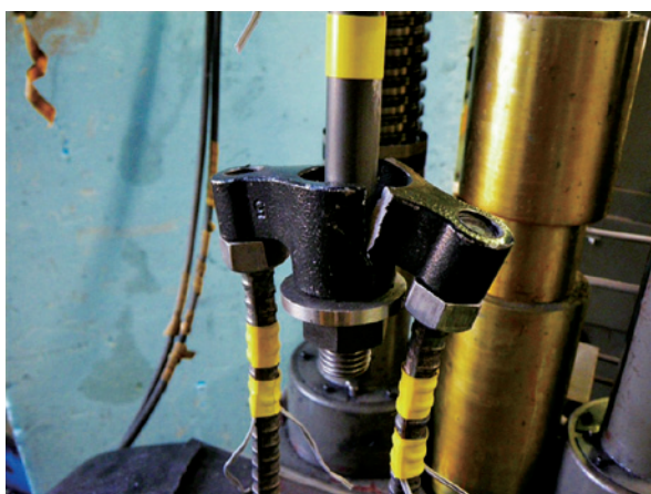
写真3 試験後の状況 試験体記号: No.2-2-1 試験項目: 一方向引張り試験
