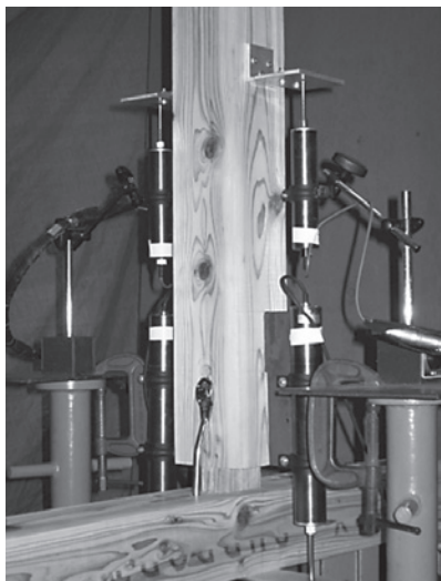
写真1 木造軸組工法接合部の試験
