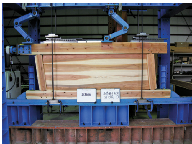
写真2 損傷状況(落とし込板壁)
