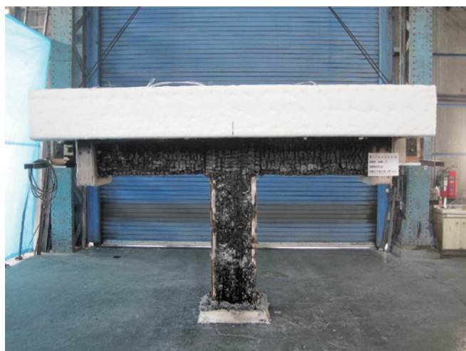
写真3 試験後の試験体の状況(仕様①)
