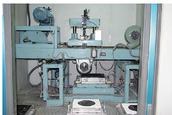
写真8 ホイールトラッキング試験装置
