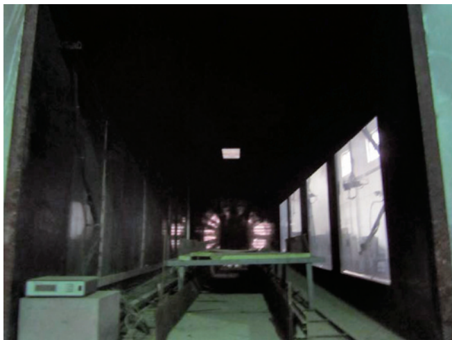
写真7 燃焼風洞の内側 (中央奥:ファン, 手前:実験スペース, 右:観測窓)
