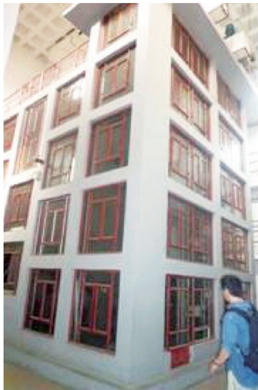
写真5 五階建て縮小実験設備 (煙流動測定)
