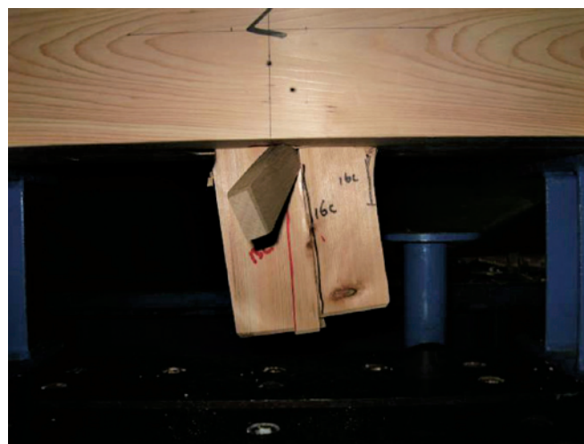
写真2 ほぞの割裂及び鼻栓の折れ
