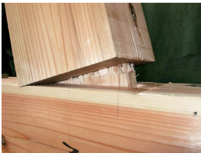
写真1 ほぞの曲げ破壊
