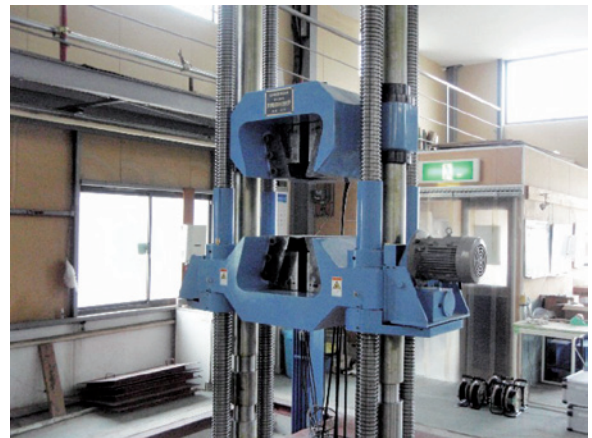
写真3 防振対策を行った新設試験機
