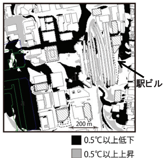
図11 地上2mにおける再開発前後の気温差の分布 (再開発後ケースの計算値－現状ケースの計算値) 撤去建物は点線、建設建物はハッチで表示している。
