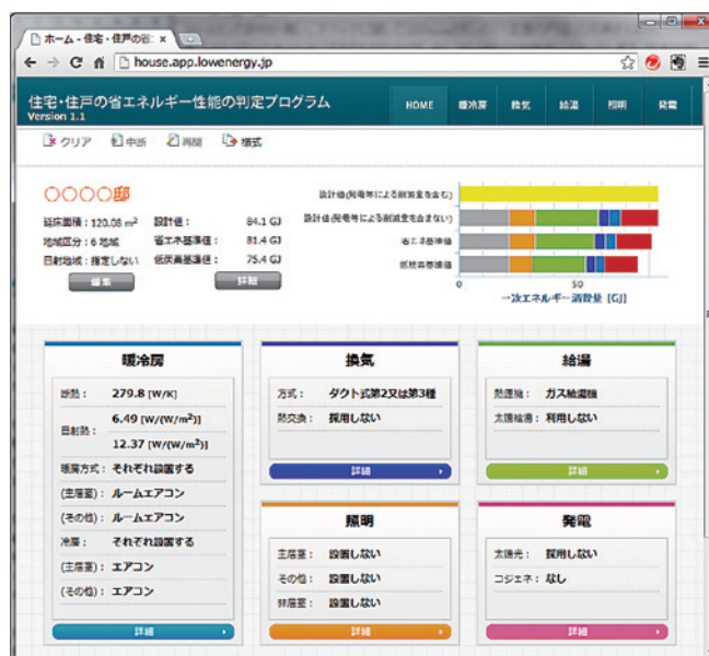
図1 低炭素認定・改正省エネ基準の判定プログラム 本プログラムで全用途合計の1次エネを計算する
