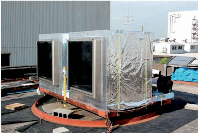
写真1 太陽光を用いた日射遮蔽係数測定状況
