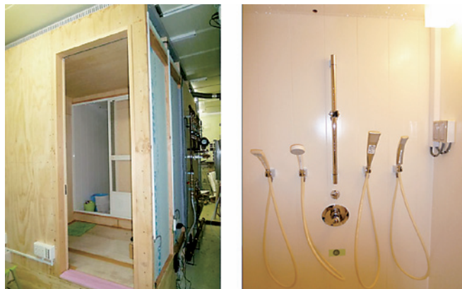
図5 シャワー被験者実験ブース 一度に4つのシャワーを試験でき、全12種類のシャワーを評価中である
