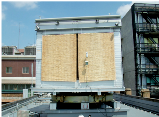
図2 大学屋上 回転実験棟における日射遮蔽実験の様子 さまざまな要素をクリアした日射遮蔽部材の開発は大きな課題
