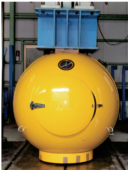
写真2 破壊状況 試験体記号: N2 Pmax=95kN ・全景
