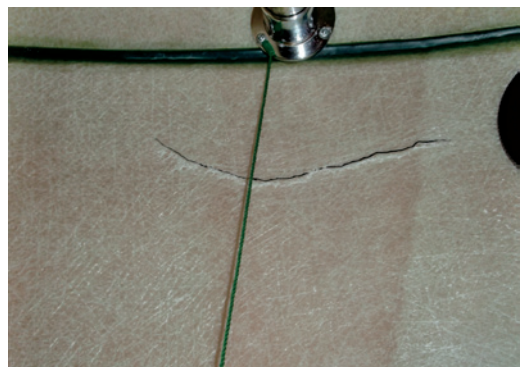
写真5 破壊状況 試験体記号: N2 Pmax=95kN ・加力点下で本体の割れ(内側)
