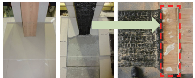
図8 耐火集成木材梁と耐火区画壁取り付け部燃焼試験
