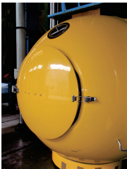
写真3 破壊状況 試験体記号: N2 Pmax=95kN ・本体の圧縮変形による出入口用ハッチの開き
