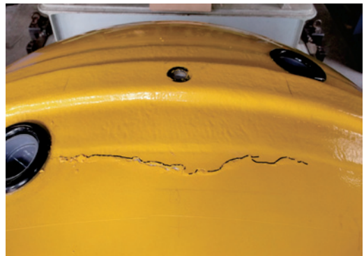
写真4 破壊状況 試験体記号: N2 Pmax=95kN ・加力点下で本体の割れ(外側)
