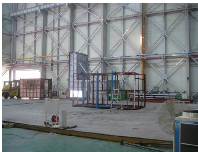
写真11 実物火災性能実験棟内部の様子 (台座の上に対象物を置いて実際に燃やす)
