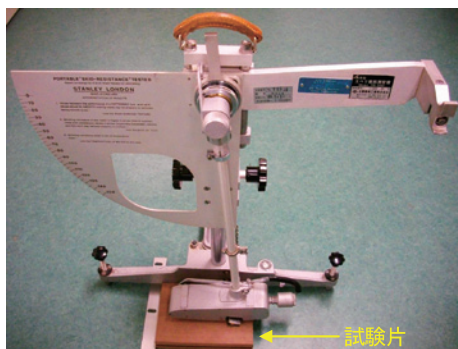
写真6 ASTM E 303による滑り抵抗性試験機
