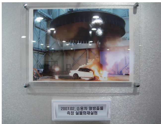
写真13 自動車の火災性能実験の様子 (KICT, 閲覧用写真パネルより)
