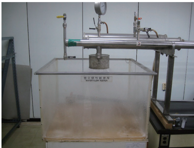
写真2 流量測定試験装置
