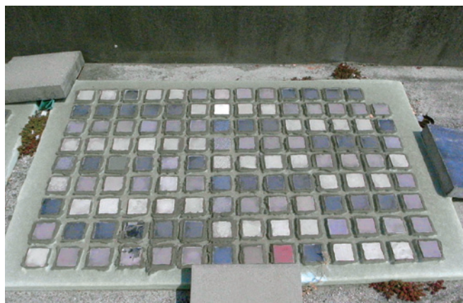
写真1 塗料の長期屋外暴露試験状況
