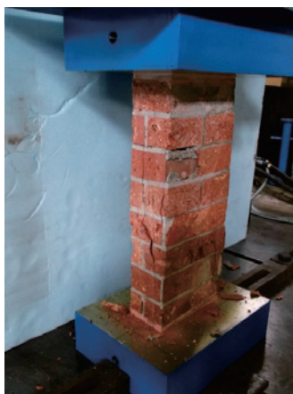
写真4 破壊状況 試験体記号: ② Pmax=321.6kN
