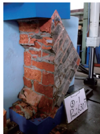
写真5 破壊状況 試験体記号: ③ Pmax=630.7kN ・せん断破壊
