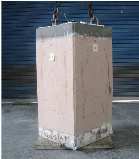
写真4 試験後の試験体の状況(試験体記号A)
