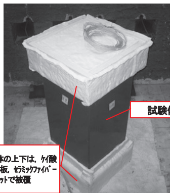
写真3 試験体の設置状況
