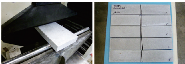
写真1 試験状況および供試体の破壊状況（ゴム板なしの場合）
