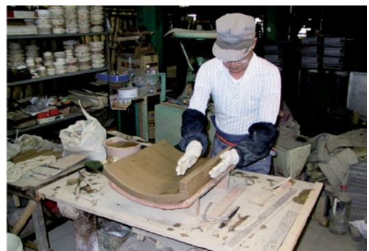
新調する平瓦の成形作業(岐阜県内)
