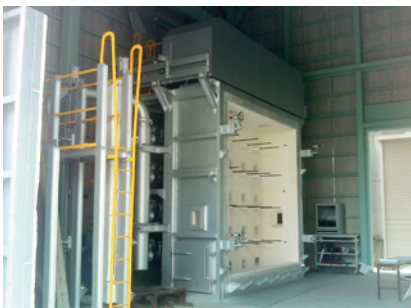
写真7 増設された防耐火試験用大型壁炉
