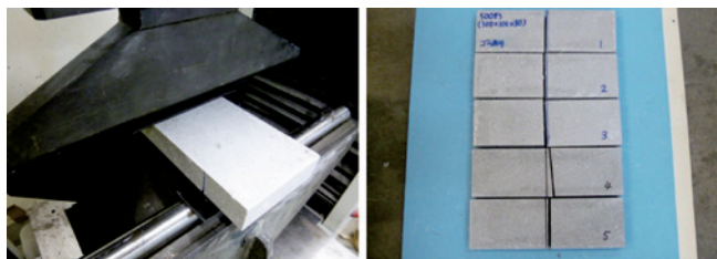
写真2 試験状況および供試体の破壊状況（ゴム板ありの場合）
