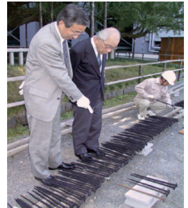
古鉄釘を茶で煮て再用する。 平井教授の指導によるタンニン酸鉄化
