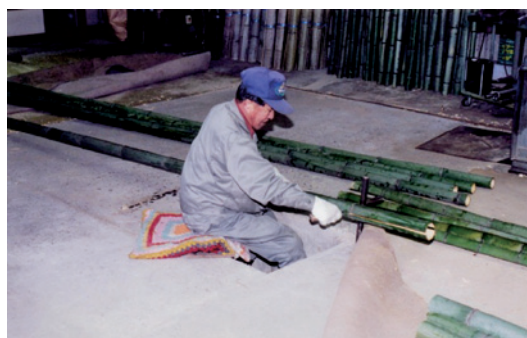
壁内部に編み込む真竹の加工 (京都府亀岡)
