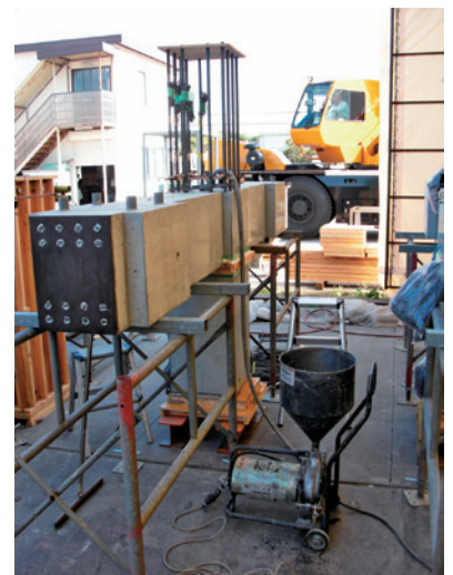
写真4 柱および梁の接合状況
