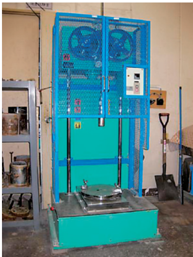
写真5 土の突固め試験装置の全景
