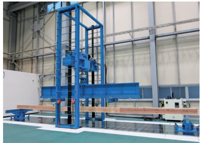
写真3 1000kN 構造物曲げ試験装置の全景 (10m 支持スパンでの試験実施状況)
