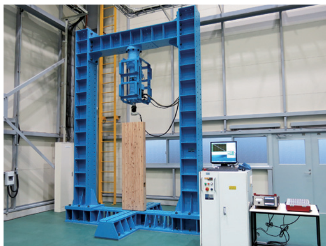
写真6 200kN 構造物試験装置の全景
