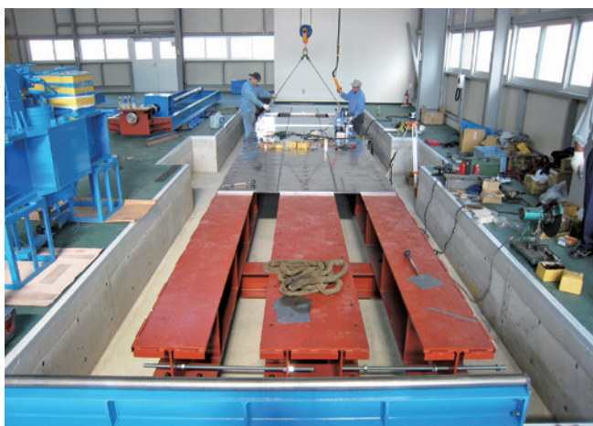
写真2 1000kN 構造物曲げ試験装置の施工状況
