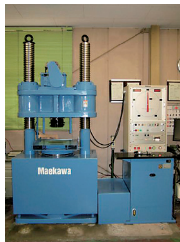
写真1 3000kN圧縮試験機の全景
