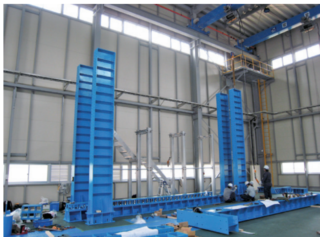
写真4 大型面内せん断試験装置の施工状況
