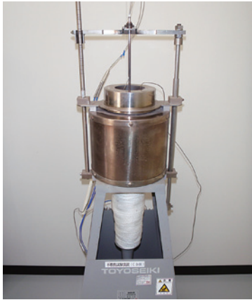
写真7 不燃性試験装置
