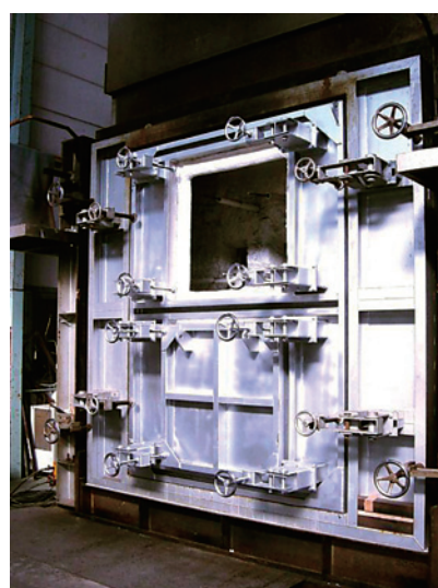
写真4 マスクパネル(壁炉に設置した状況)
