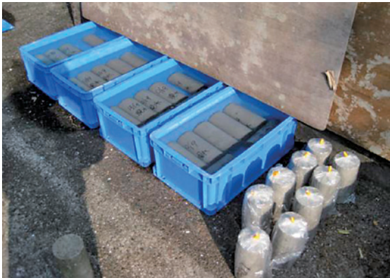
写真6 供試体の養生状況 (現場水中養生および現場封かん養生)
