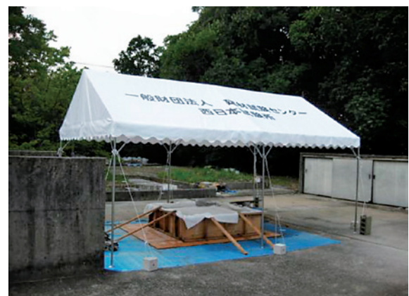
写真5 母材の養生状況
