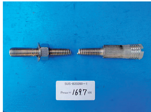
写真3 破壊状況 試験体記号: SUS-B20200-1 最大荷重: 169.7kN ・破断箇所
