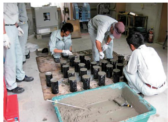
写真4 圧縮強度試験用供試体の作製状況
