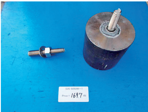
写真2 破壊状況 試験体記号: SUS-B20200-1 最大荷重: 169.7kN ・テーパ付ボルトねじ部の破断
