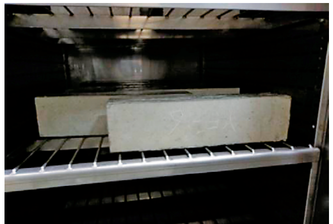
写真3 中性化促進試験装置の試験槽内
