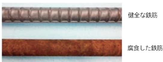
写真1 鉄筋の発錆状況の例
