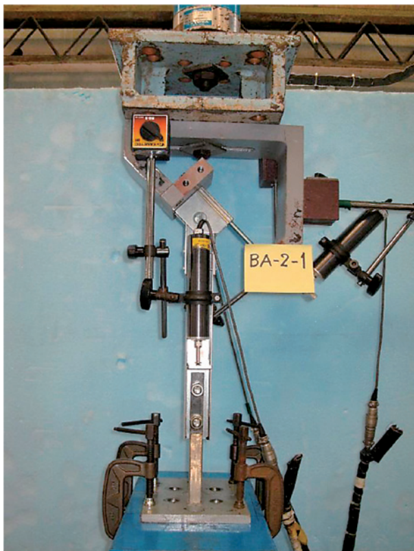
写真7 斜め部材の上端接合部の試験実施状況
