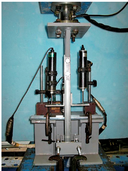
写真3 クリップ接合部の野縁方向の水平荷重試験状況
