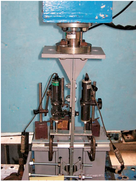
写真4 クリップ接合部の野縁受け方向の水平荷重試験実施状況
