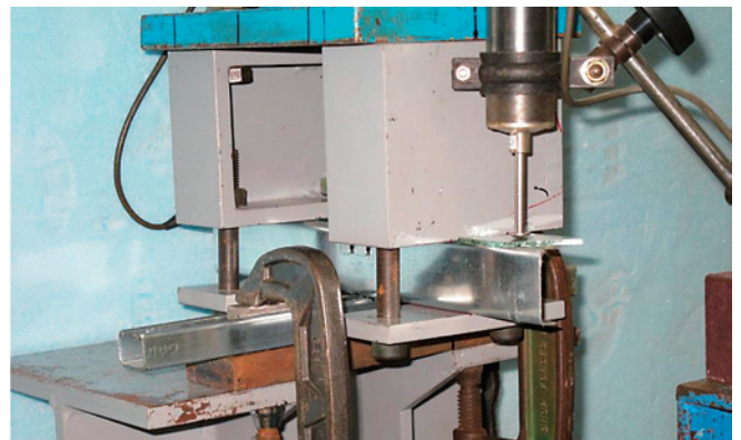
写真2 クリップ接合部の引張試験実施状況
