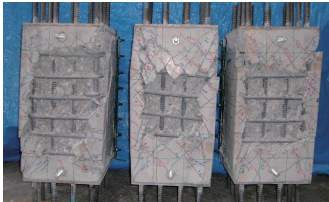
写真3 実験終了後の損傷状況
