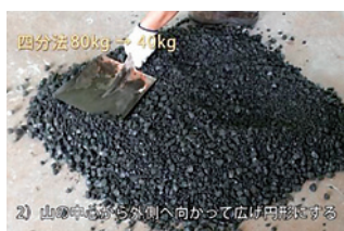
粗骨材 細骨材 図4 四分法による縮分(試料を広げる)
