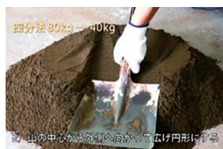
粗骨材 細骨材 図4 四分法による縮分(試料を広げる)
