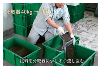
図7 試料分取器による縮分
