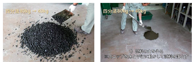
粗骨材 細骨材 図3 四分法による縮分(全ての試料で山を作る)
