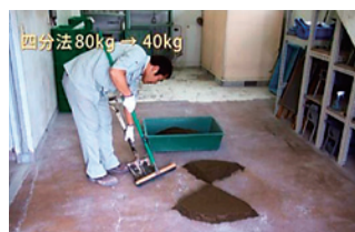
粗骨材 細骨材 図6 四分法による縮分(対角の試料を合わせる)
