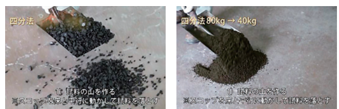
粗骨材 細骨材 図2 四分法による縮分(試料の山を作る)
