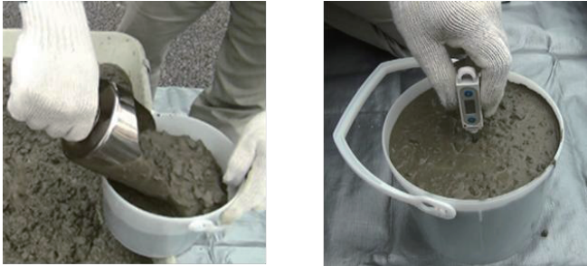
写真4 コンクリート温度試験
