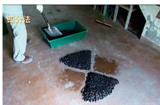
粗骨材 細骨材 図6 四分法による縮分(対角の試料を合わせる)
