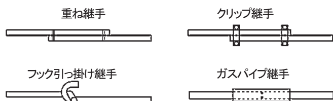
図1 明治から大正期の主な鉄筋継手工法
