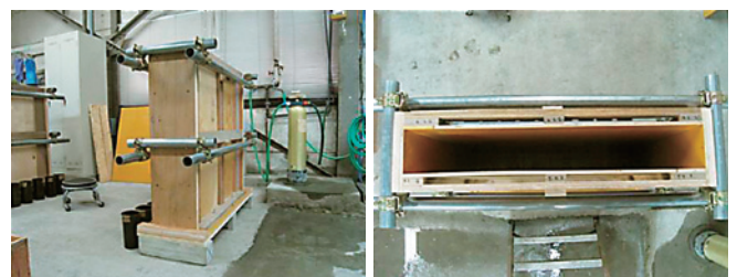
写真4 模擬供試体用型枠の外観
