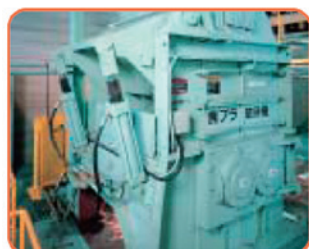
非塩化ビニル系廃プラスチック類処理ライン用破碎機
