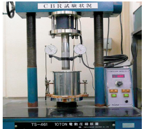
写真1 貫入試験状況
