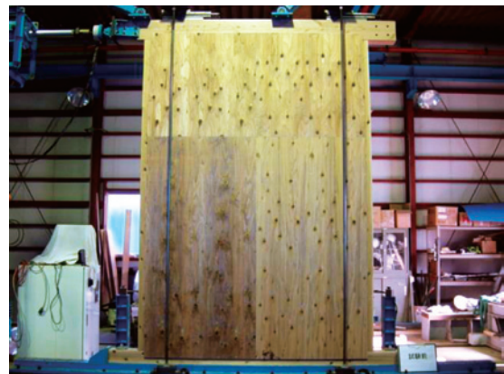
写真1 壁の面内せん断試験の一例 （合板耐力壁）
