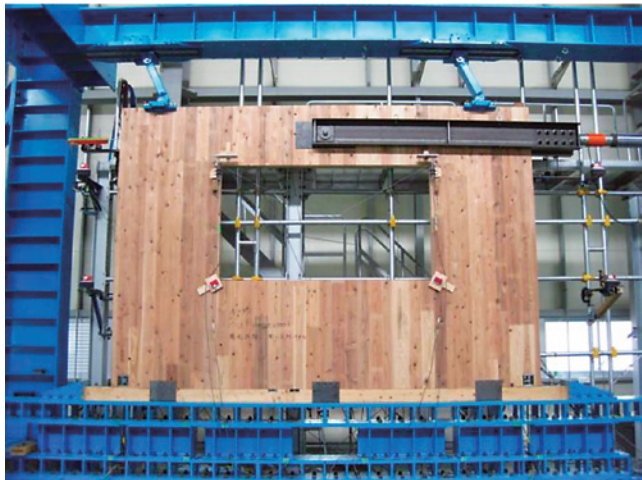
写真9 CLTを用いた壁の面内せん断試験 (有開口試験体)
