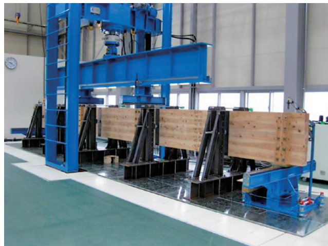
写真6 製材重ね梁の実大曲げ試験
