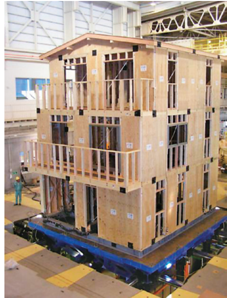
写真11 実大振動台実験 (木造軸組構法, 3階建て)
