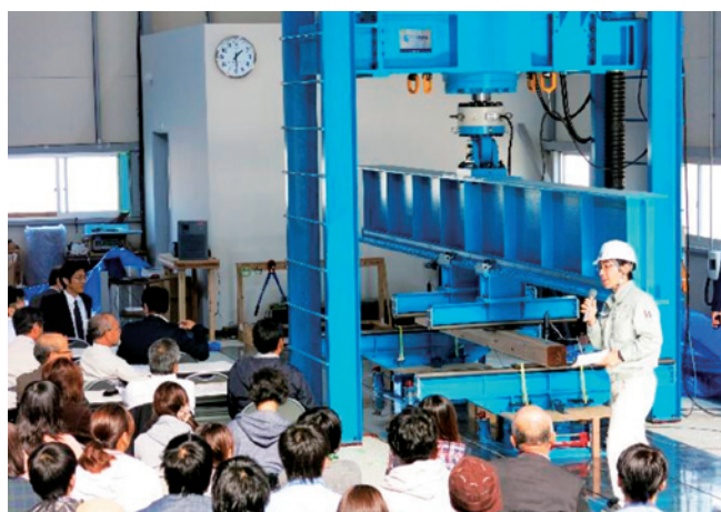
写真6 木材の曲げ試験説明
