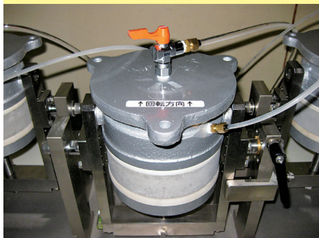
写真2 透水容器内の空気の除去状況
