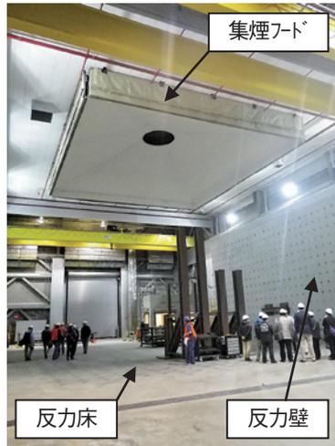
写真4 実大火災験棟の様子
