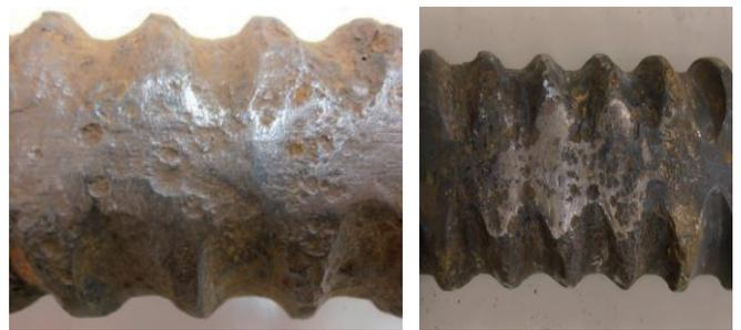
写真3 5%腐食鉄筋(左:電食, 右:塩水噴霧)
