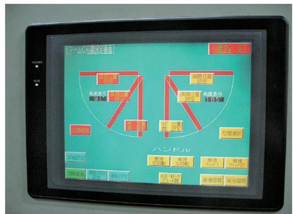
写真2 開閉繰り返し試験装置[制御盤]
