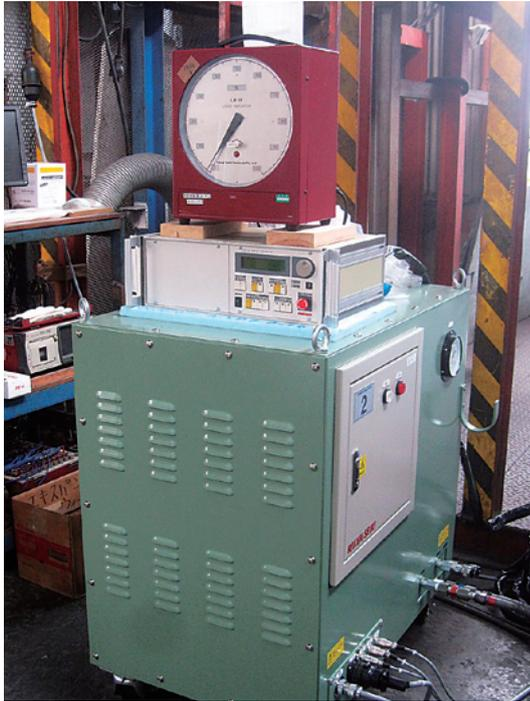
写真1 自動制御静的加力装置
