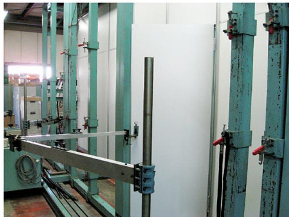
写真4 可動間仕切の開閉繰り返し試験状況
