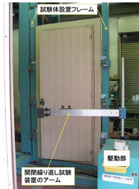
写真1 開閉繰り返し試験装置
