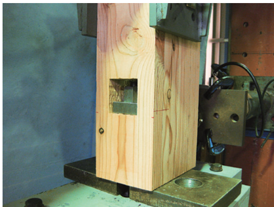
写真1 試験体(カラマツ, せん断長さ120mm)
