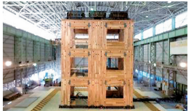
図2 小幅パネルによる箱形試験体の振動実験
