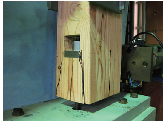
写真4 破壊状況(木材のせん断破壊)
