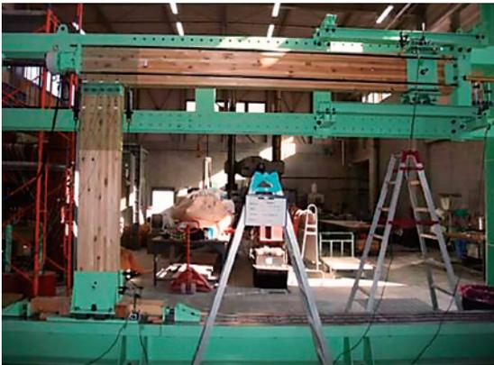
写真17 柱梁接合部・梁勝ち仕様(L型接合部試験体)
