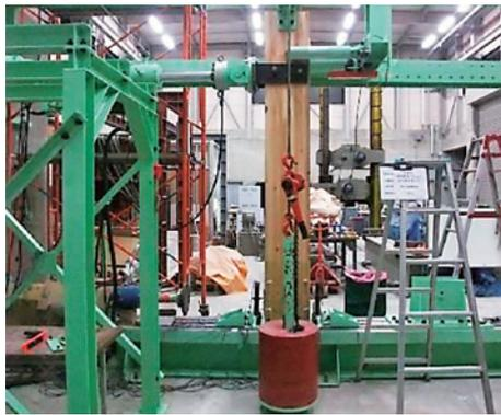
写真11 柱脚仕様(I型接合部試験体)
