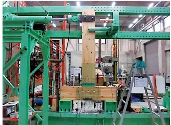
写真14 柱梁接合部・柱勝ち仕様(T型接合部試験体)
