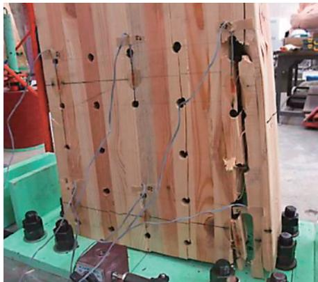
写真12 I型接合部試験体破壊性状(FRPなし)
