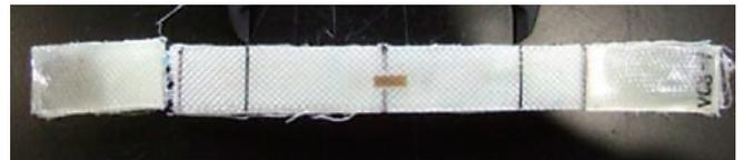
写真5 ビニロンクロス(VC8)の破断性状
