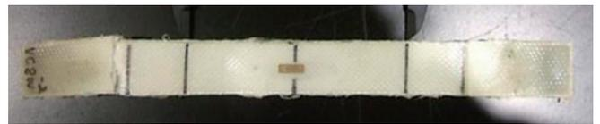
写真6 ビニロンクロス2層(VC8W)の破断性状
