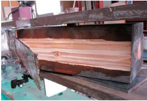
写真9 暴露試験体の破壊性状(FRP試験体)
