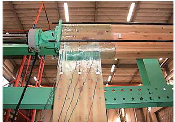
写真19 L型接合部試験体破壊性状(FRPあり)
