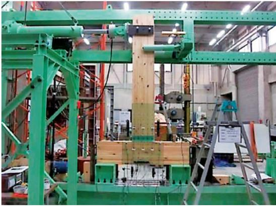
写真16 T型接合部試験体破壊性状(FRPあり)
