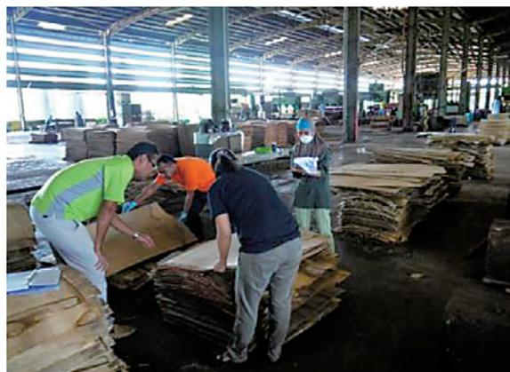
写真10 OPTのベニヤコア材を評価している様子
