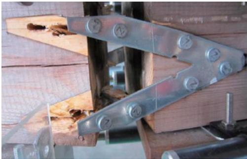
写真10 暴露試験体の破壊性状(金物試験体)
