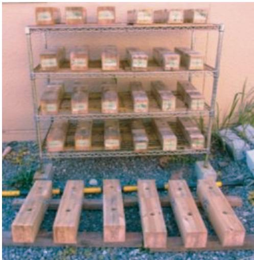
写真8 屋外暴露試験体
