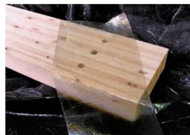
写真2 紫外線硬化型FRPの外観
