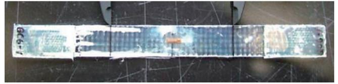
写真3 ガラスクロス(GC6)の破断性状
