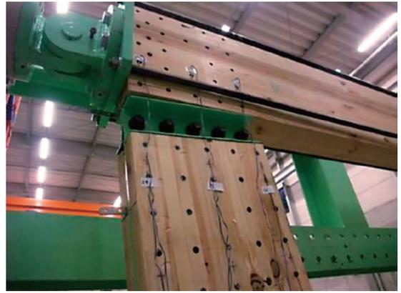
写真18 L型接合部試験体破壊性状(FRPなし)
