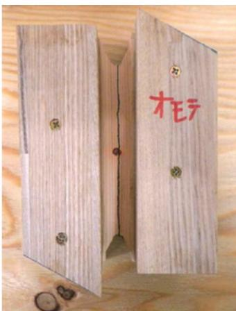
写真4 破壊状況（試験体中央部での木材のせん断破壊）
