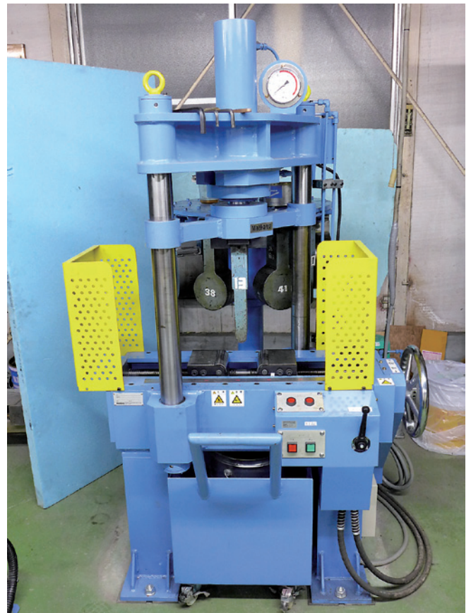
写真1 油圧式 300kN 金属材料曲げ試験機
