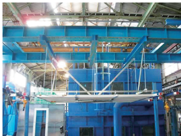
写真2 システム天井試験体
