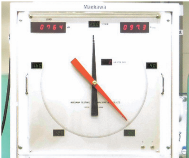
写真3 荷重表示部 (左上のデジタル表示部が荷重, 右上が応力)
