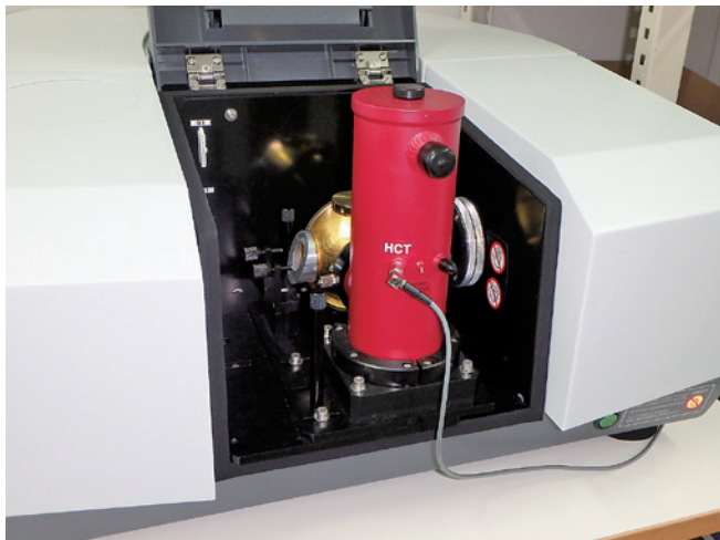
写真3 赤外分光光度計(FTIR)用積分球を設置した状態
