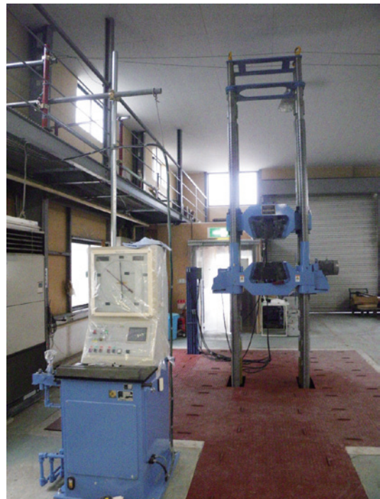
写真4 高機能多様型2000kN万能試験機
