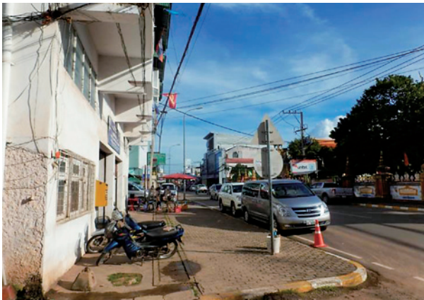
写真の右から、車道、歩道、Reservation Zone。Reservation Zoneの上空(高さ3m以上)は、1.2mの幅まで建物を突き出すことが認められている。幅まで建物を突き出すことが認められている。
