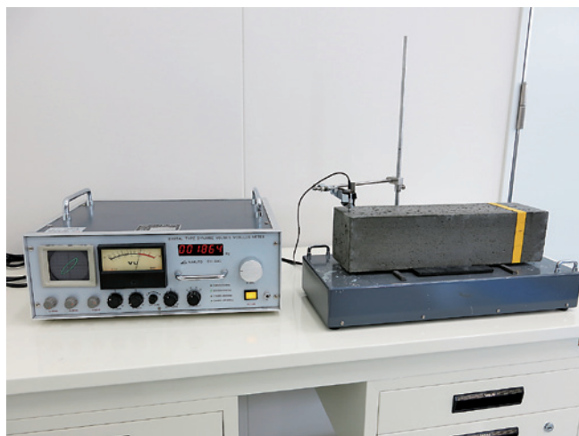
写真3 たわみ振動の一次共鳴振動数測定状況
