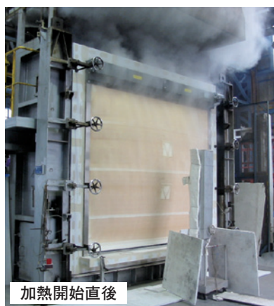
写真3 耐火クロス製スクリーン(ファイアカーテン)の遮炎性能試験の例(当センターでの60分加熱試験)
