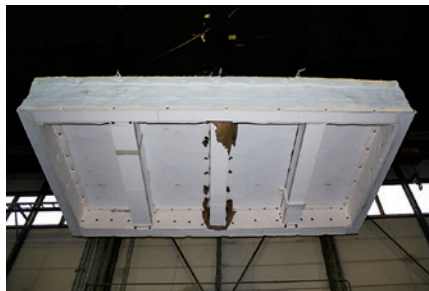
写真4 試験後の加熱側の状況
